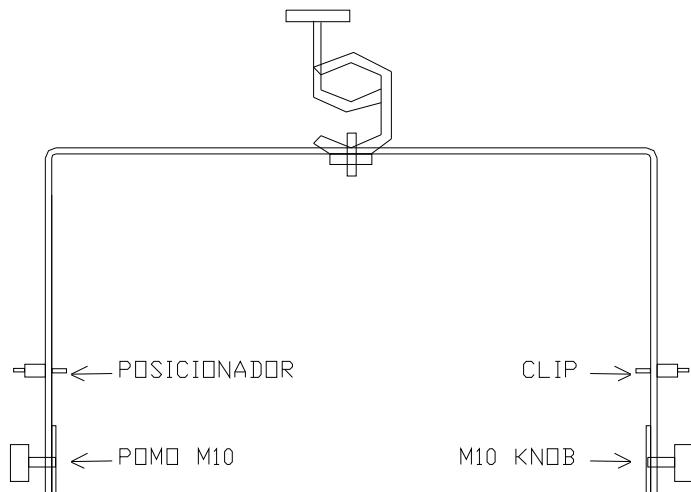
4- Colocar el soporte UB-X en la caja X12CE o X15CE. Fijar ambos laterales por los pomos de M10 y colocar el posicionador en una posición aleatoria (simplemente para bloquear el sistema). Más tarde se ajustará la graduación. Gire la anilla del posicionador para bloquear/desbloquear.
