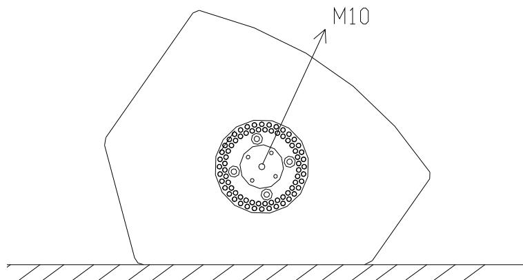
**2-** Colocar en el soporte UB-X el accesorio opcional GT-50 (garfio para colgado). Bloquear correctamente con una tuerca autoblocante. Usar el punto central indicado con una flecha.
