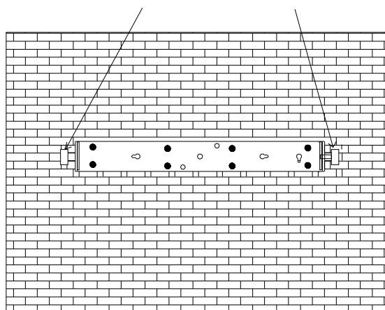
**4-** Coloque la caja entre el soporte y la pared y fíjela con los dos pomos de M10
