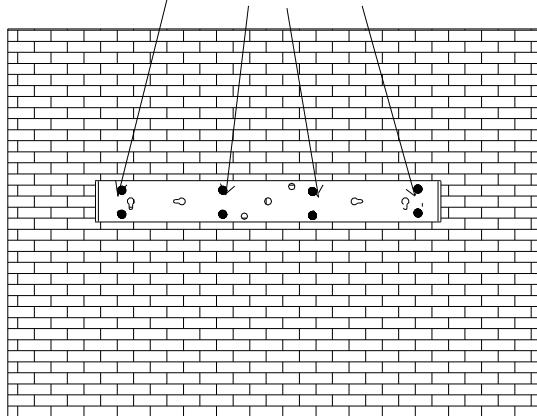
**3-** Coloque los dos pomos de M10 en los laterales del soporte.
