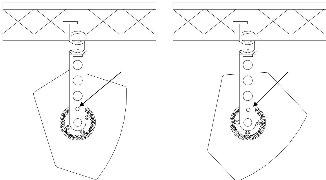
7-Puede usar la eslinga (kit opcional SC-15X) como medida de seguridad adicional, colocándola alrededor del asa y alrededor de la barra del truss.
