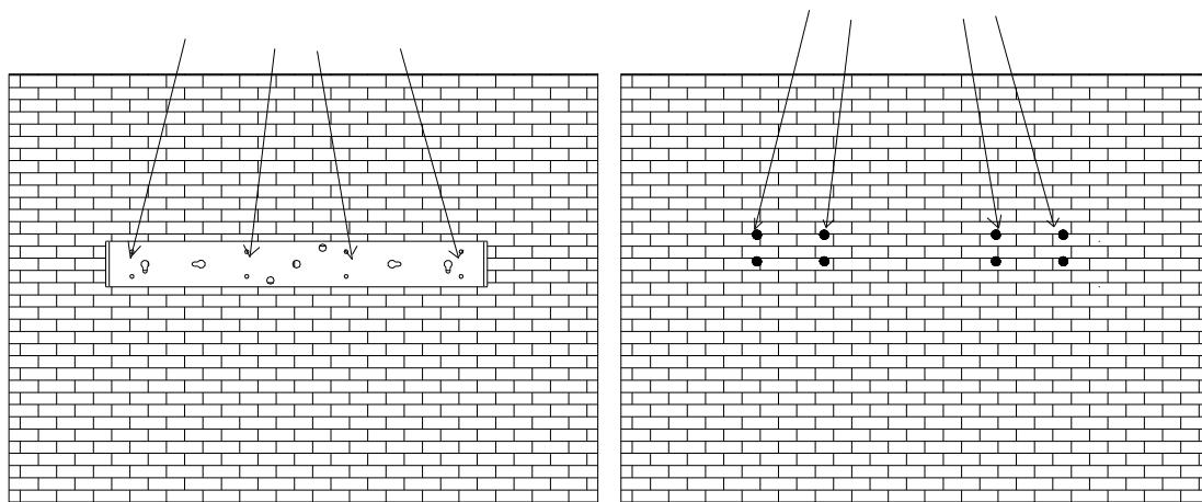
**2-** Realice los taladros en la pared y cuelgue el soporte con tornillería adecuada y de alta resistencia.
